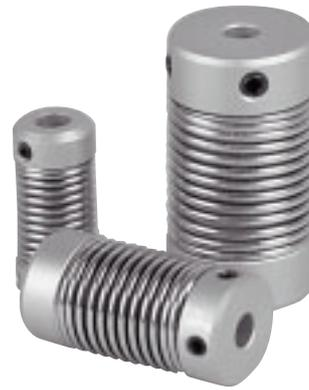
Los acoplamientos SPRING-FLEX se basan en la utilización de un resorte helicoidal como elemento elástico de transmisión. Estos resortes se construyen en acero inoxidable y de sección ovalada. Los extremos del muelle se mantienen roscados y fijados a los núcleos que son de aleación de aluminio.
